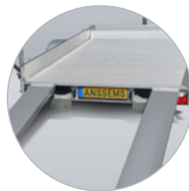
Aluminium rijplaten in geïntegreerde rijplaathouders
