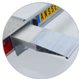
Aluminium rijplaten in geïntegreerde rijplaathouders
